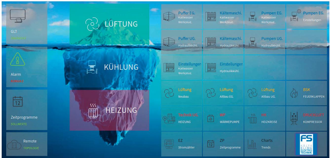
Zentrale MSR-Steuerungsoberfläche (Messen, Steuern, Regeln): Alle Anlagenzustände und Energieflüsse für Lüftung, Kühlung und Heizung im Überblick – intuitiv steuerbar und in Echtzeit überwacht. © Schlittenhardt/Hauff
